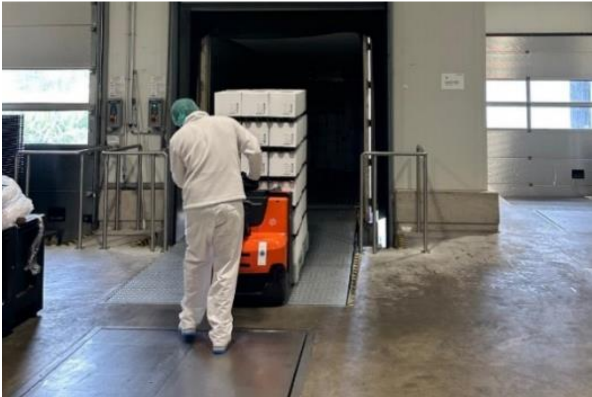
Abbildung 19: Diese Abbildung zeigt die Verladung von fertig verpackter und etikettierter Ware in einen vorgekühlten Transportcontainer.
